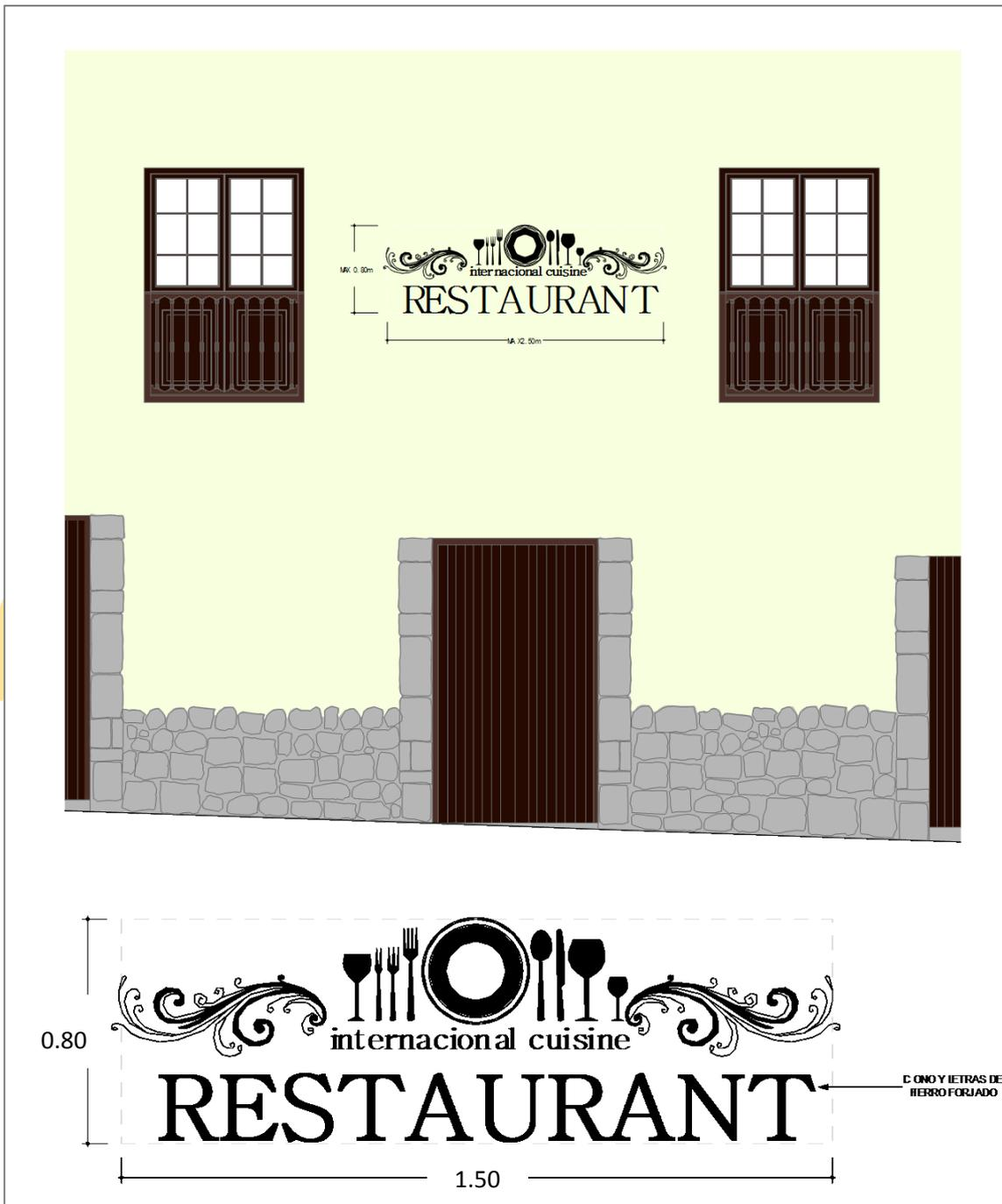
**GRÁFICO 28:** Esquema del diseño y ubicación del aviso comercial sin tablero de fondo, en fachada en segundo nivel
